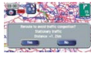
119 TMC-Einheit H001EFG301 W Gibt Verkehrsmeldungen durch und errechnet Ausweichrouten zum Umfahren von Staus. *Für AV-Navigationssystem H001EFG001. Untersitzkonsole H6210FG900 zusätzlich notwendig.
