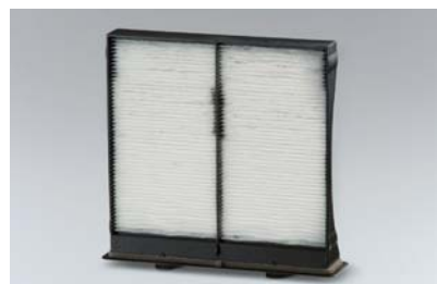
106 Innenluftfilter 72880FG000 W Vermindert das Eindringen von Staub und Pollen in den Innenraum. Um die Wirkung zu erhalten, sollte der Filter jährlich oder alle 12.000 km gewechselt werden. *Zum Austausch des Originalfilters.
