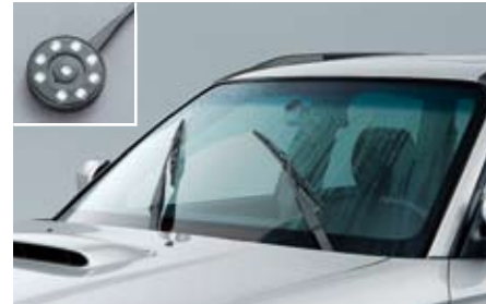
55 Regensensor SEWAYA8000 ★ E Aktiviert die Scheibenwischer sobald Wasser auf die Scheibe fällt. *Mit beleuchtetem Schalter zum Aktivieren/Deaktivieren
