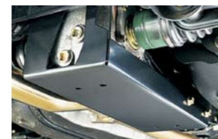
36 Differenzialschutz B031SSA000 ★W Zum Schutz des hinteren Differenzials vor Beschädigungen von unten.
