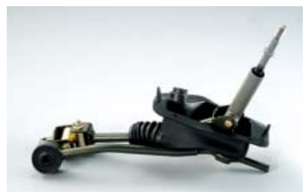
94 STI, Kurzschaltgestänge (5-Gang) C1010SA000 ★ W Für kürzere Schaltwege, schnelleres und noch präziseres Schalten. *Nicht für Fahrzeuge mit Dual-Range
