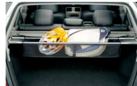
66 Heckablage F5510SA100 ★ W Hält das Transportgut fest. Tragfähigkeit: 5kg. Größe: 1.000 x 150 x 190 mm.
