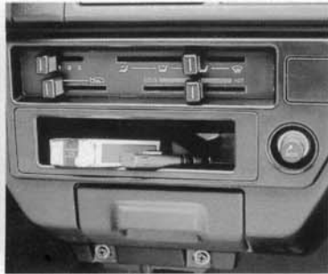
Zusätzliche Ablage, bzw. Radio-Schacht
