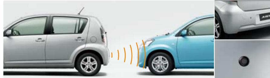
**39** Ultraschall Einparkhilfe mit 2 Sensoren für hinten
