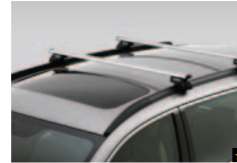
46 Aluminium-Dachgrundträger C-Slot E365EAJ100 Perfekt in Design und Funktion. Ein leichtgewichtiger, stabiler Träger.
