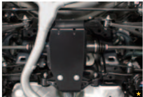
44 Differenzialschutz hinten E515EAJ300 Zum Schutz des Differenzials vor Beschädigungen von unten. Einbausatz zur Montage zusätzlich notwendig.
