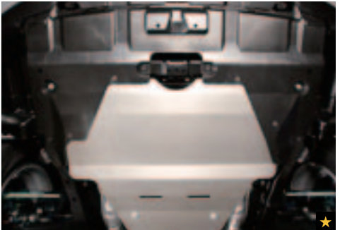
41 Motorunterfahrerschutz (Aluminium) E515EAJ100/E515EAJ120 Zum Schutz des Motors vor Beschädigung von unten. Einbausatz zur Montage zusätzlich notwendig.
