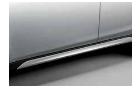
30 Kunststoffseitenblendensatz Aluminiumoptik E265EAJ000 Zum Schutz des Fahrzeugs vor Steinschlag. Verstärkt die Offroad-Optik.
