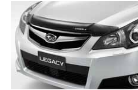
27 Motorhaubenschutz E231EAJ000 Schützt die Motorhaube vor Kratzern und Steinschlag.
