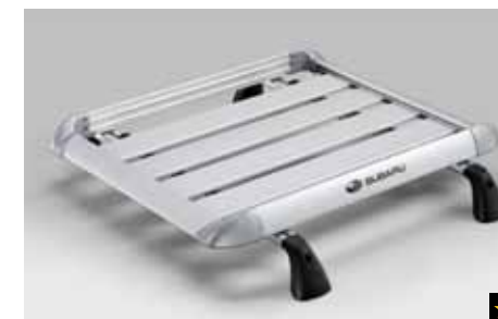
44 Gepäckkorbaufsatz E365ESC200 Für zusätzliche Ladung/Gepäck. Abmessungen Ladefläche: 900 x 800 mm. Verwendung mit Aluminium-Dachgrundträger.
