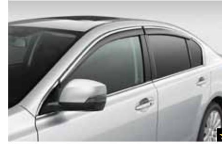
1 Seitenwindabweisersatz E3610AJ000/E3610AJ300 Verhindert bei schlechtem Wetter das Eindringen von Regen/Schnee beim Fahren mit leicht geöffnetem Fenster.
