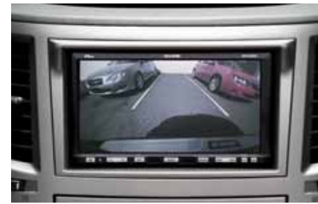
113 CCD Rückfahrkamera mit 270.000 Pixel SEFTAJ6100
