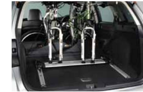
66 Fahrrad aufsatz zu Laderaumschienen-System L0010AJ007 Transport von 2 Fahrrädern mit ausgebauten Vorderrädern im Innenraum. Laderaumschienen-System zusätzlich erforderlich.
