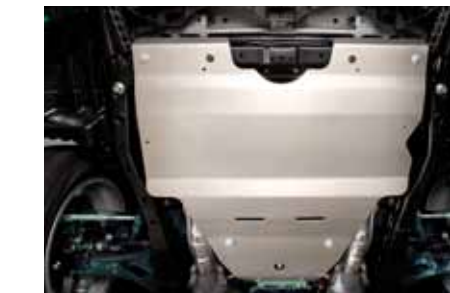
32 Motorunterfahrerschutz (Aluminium) E515EAJ100/E515EAJ120 Zum Schutz des Motors vor Beschädigung von unten. Einbausatz zur Montage zusätzlich notwendig.
