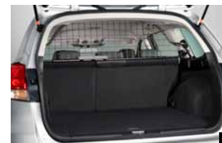
84 Laderaumtrenngitter F555EAJ000 Trennt den Laderaum vom Insassenbereich. Auch zur Verwendung von ISOFIX Kindersitzen geeignet.
