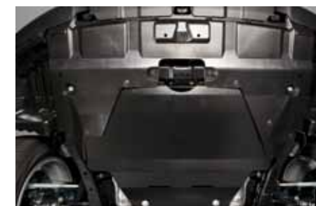
33 Motorunterfahrerschutz (Stahl) E515EAJ000/E515EAJ020 Zum Schutz des Motors vor Beschädigung von unten. Einbausatz zur Montage zusätzlich notwendig.
