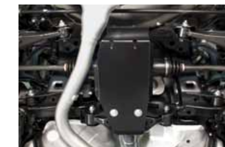
35 Differenzialschutz hinten E515EAJ300 Zum Schutz des Differenzials vor Beschädigungen von unten. Einbausatz zur Montage zusätzlich notwendig.
