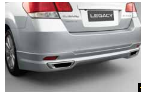
5 Heckschürze E5610AJ110NN Für ein sportliches Aussehen. Abdeckblende bei Fahrzeugen mit Einrohr-Auspuffanlage erforderlich. *Lackierung erforderlich
