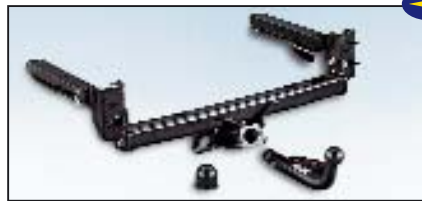
Anhängerkupplung abnehmbar, System AL-KO
