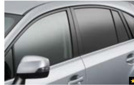
12 Chromoptik-Zierleisten Seitenfenster SEBDFJ3200 Betonnt die Seitenscheibenkontur durch die eleganten, attraktiven Chromzierleisten.
