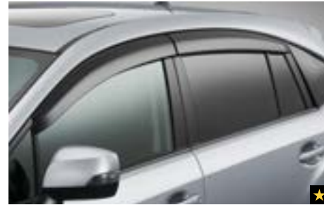
11 Seitenwindabweisersatz E3610FJ600 Verhindert bei schlechtem Wetter das Eindringen von Regen/Schnee beim Fahren mit leicht geöffnetem Fenster.
