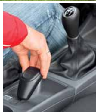
Praktisch: Die Getriebeuntersetzung nutzt beim Gespannfahren.
