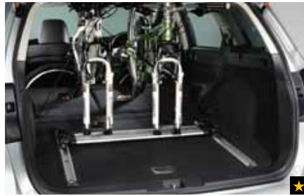
66 Fahrradmitschleppsystem zu Laderaumschienen-System L0010AJ007 Transport von 2 Fahrrädern mit ausgebauten Vorderrädern im Innenraum. Laderaumschienen-System zusätzlich erforderlich.
