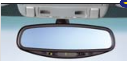
Selbstabblendender Innenspiegel mit Kompass H501ESA000
