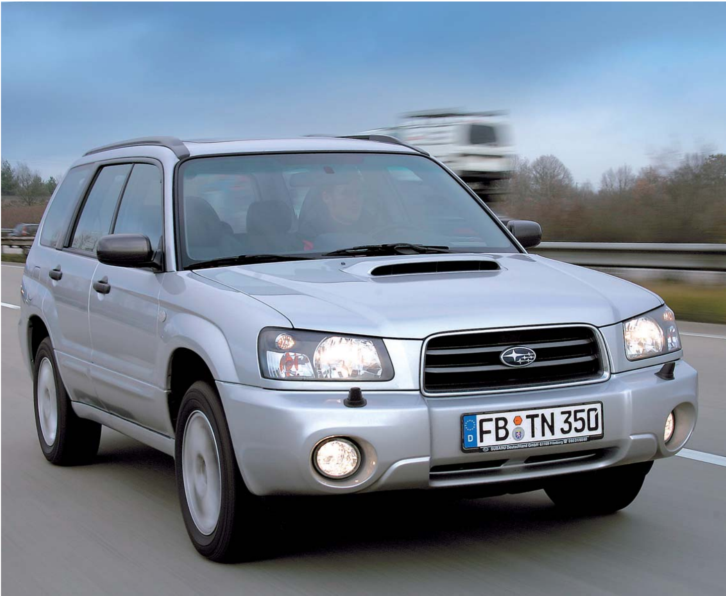
Die Hutze auf der Motorhaube ist das Erkennungsmerkmal eines Turbo-Forester. Sie dient der Luftzufuhr zum darunter liegenden Ladeluftkühler
