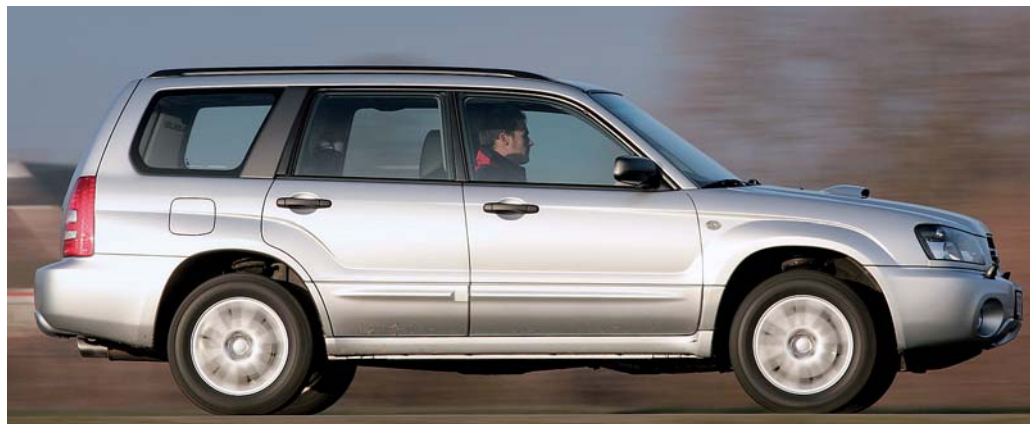
Mit 195 mm Bodenfreiheit kann sich der Forester auch im Gelände sehen lassen. Die lange Nase setzt früh auf
