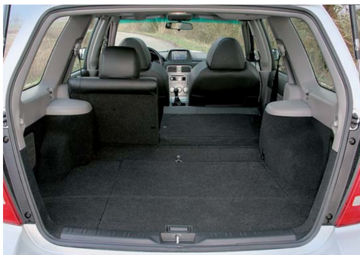
Der Gepäckraum ist mit 920 bis 1680 mm zwar ausreichend lang, aber vergleichsweise niedrig. Die Rückbanklehnen lassen sich zackig umklappen
