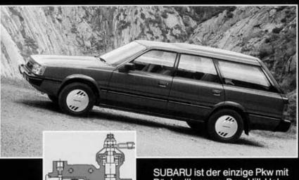
Rückrollbremse "Hill-Holder" SUBARU ist der einzige Pkw mit Rückrollbremse. Der "Hill-Holder" verhindert das unfreiwillige Zurückrollen z.B. am Berg, vor Ampeln mit ansteigender Fahrbahn oder in steilen Garagenausfahrten. (Nur in Verbindung mit Schaltgetriebe.)
