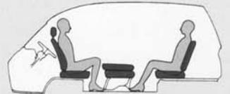
Beide Frontsitze lassen sich bei einer Rast nach hinten drehen. Die zusammengeklappte mittlere Sitzbank wird zum Tisch.
