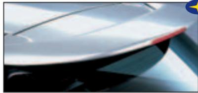
**Dachspoiler mit Bremsleuchte**
