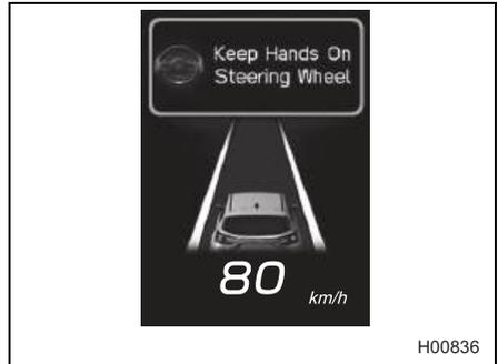
Wenn das System weiterhin keinerlei Lenkbewegung erkennen kann, wird die Spurhaltefunktion vorübergehend abgebrochen. Das System benachrichtigt den Fahrer durch einen Unterbrechungsbildschirm auf der Kombiinstrumentenanzeige und durch eine Benachrichtigung (ein kurzer Signalton und ein langer Signalton).
