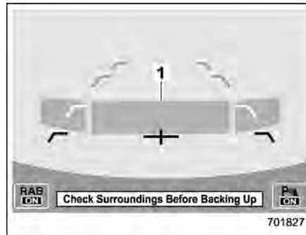
Warnung geringer Abstand (Fahrzeug nähert sich stärker dem Gegenstand)
