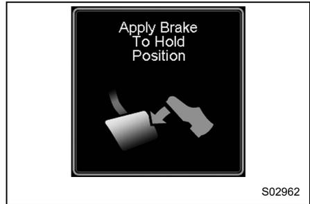
Ein Unterbrechungsbildschirm erscheint und verbleibt auf der Kombiinstrumentenanzeige, um anzuzeigen, dass das Notbremssystem mit Kollisionswarner aktiviert wurde.
