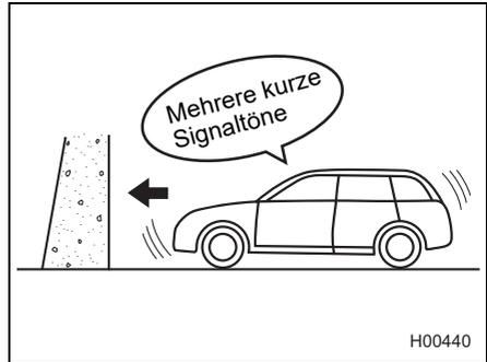
Wenn das System eingreift, wird ein Warnsignal mit wiederholten kurzen Signaltönen ausgegeben, und es wird ein Unterbrechungsbildschirm angezeigt.
