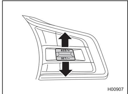
Wenn der konventionelle Geschwindigkeitsregler aktiviert wird, erlischt **READY** (Anzeige READY), die eingestellte Fahrgeschwindigkeit wird angezeigt und
