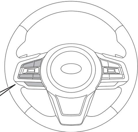
**Drücken:** Schalten Sie das Audio-/Videosystem ein oder wechseln Sie den Audioquellenmodus
