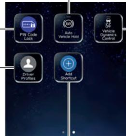
Schalten Sie das Fahrzeugdynamikregelungssystem ein/aus.
