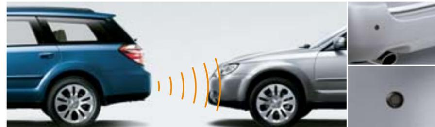
**77** Ultraschall Einparkhilfe mit 2 Sensoren für vorne, 4 Sensoren für hinten
