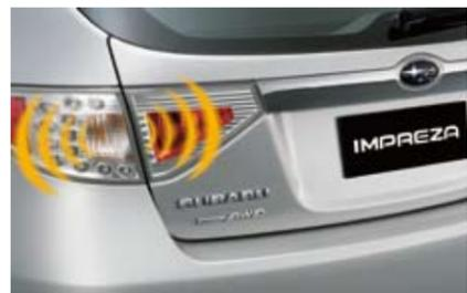
**97 Komfort Blinkmodul mit Notfallwarnblinkfunktion**
