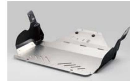
**19 Motorunterfahrerschutz (Aluminium)**
