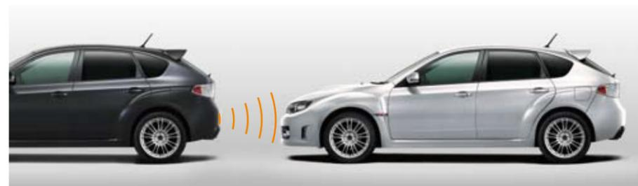
**92 Ultraschall Einparkhilfe mit 4 Sensoren für hinten**
