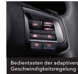
Bedientasten der adaptiven Geschwindigkeitsregelung
