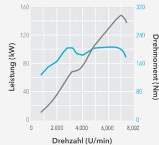
**MAX. LEISTUNG:** 147 kW (200 PS) bei 7.000 U/min
