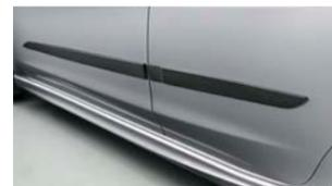
Seitenschutzleistensatz - Carbonoptik
