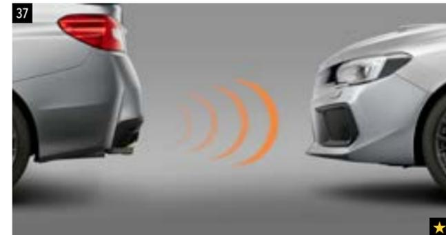
**37** Ultraschall Einparkhilfe für hinten
